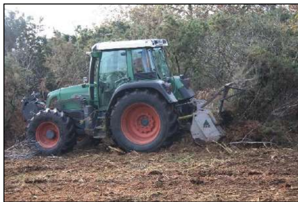
Actions de restauration sur les landes dégradées : broyeur exportateur (à gauche) et broyeur forestier (à droite)
