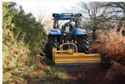
Broyage des chemins au broyeur à marteaux
