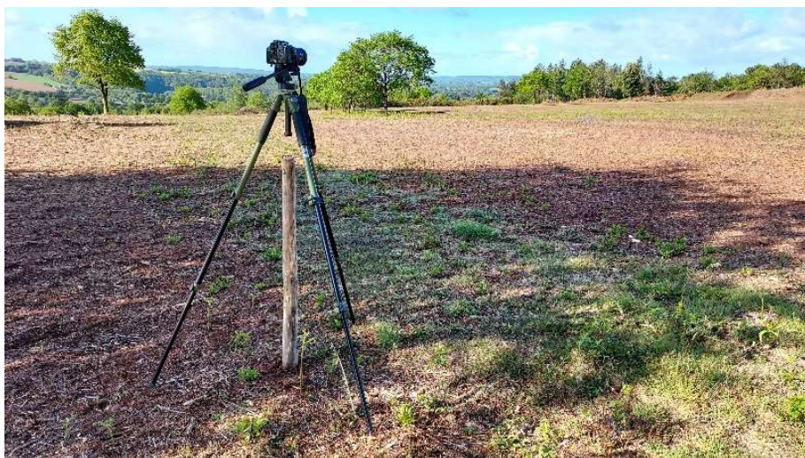
Dispositif photo avec piquet de repérage en vue de la reproductibilité de l'opération
