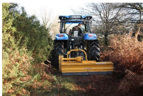
Broyage des chemins au broyeur à marteaux
