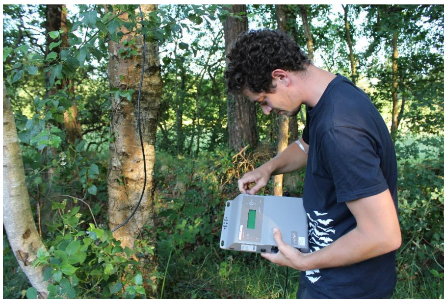
Photo 5: Pose d'un détecteur/enregistreur d'ultrason SM3Bat – Source Amikiro
